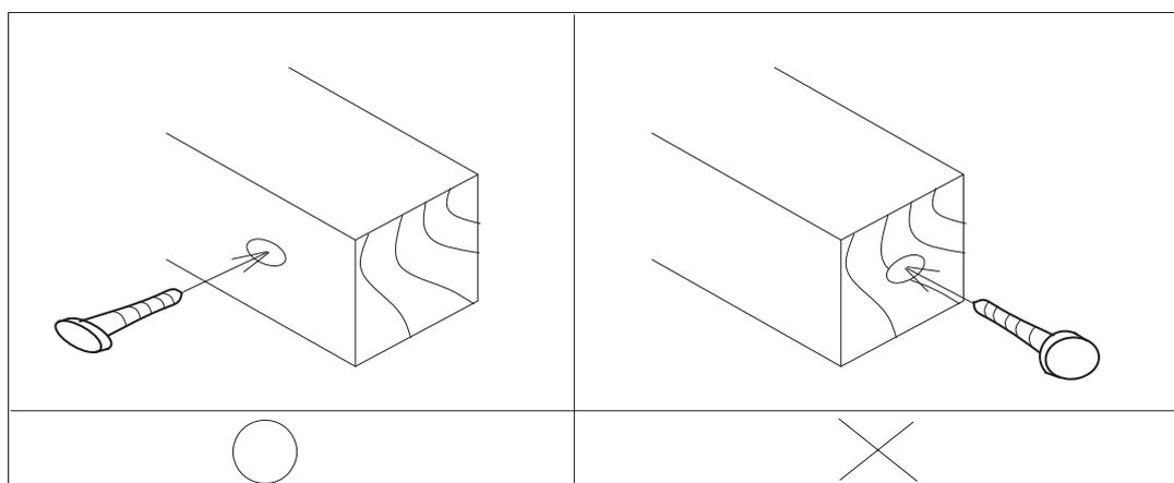
ワイヤーのかける方向は、張力の発生する方向と同じ方向には締め込まないでください。抜けの原因になります。
