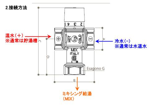
※注意 温水(+)と冷水(-)の水圧は同圧としてください。 同圧でない場合には、温水(+)側へ逆流する恐れがあります。 やむを得ない場合には、温水(+)側に逆止弁を設置してください。
