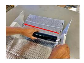
③ガラス管の口が反射板「ガラス管上穴」から 抜けていることを確認して引き出します。
