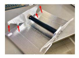
②ガラス管を持ち、矢印の方向に押します。
