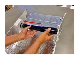
②ガラス管の口を反射板「ガラス管上穴」に入れます。
