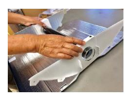
④反射板のスリットを差込み、ダボで固定して(8箇所) 完成です!!
